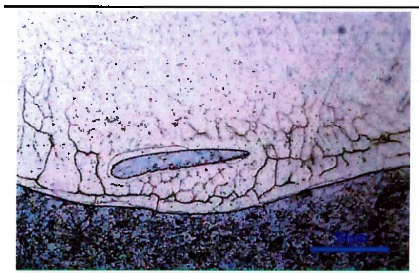
Figura 5-12 – Micrografia ótica da interface da solda de amanteigamento do aço AISI 4130M, com ataque eletrolítico com Água Régia para revelação do metal de solda.
