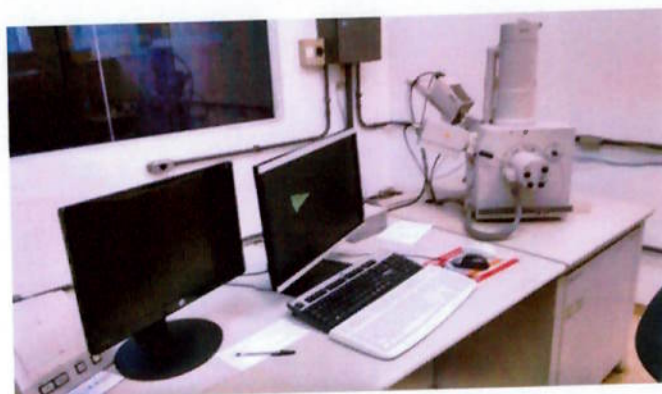
Figura 4-3 – Imagem do Microscópio Eletrônico de Varredura com a respectiva especificação técnica / Marca SEM-FEG JSM-6701F – JEOL (Cortesia IPEN)
