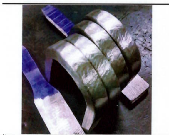
Figura 5-18 – Fotografia mostrando as regiões das soldas e da ZAC das seções transversais dobradas dos corpos de prova, após o ensaio de dobramento.
