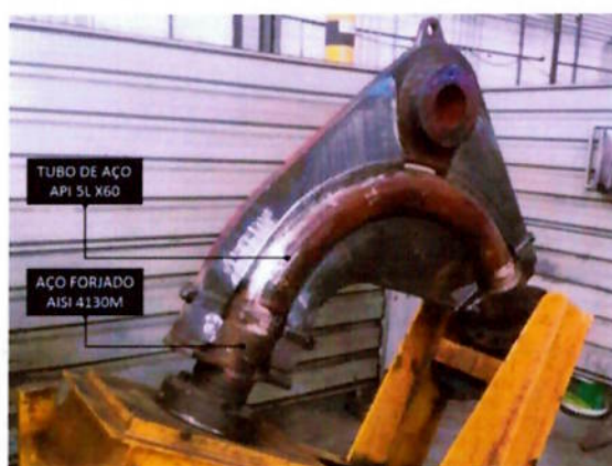
Figura 2-1 – Fotografia de um conector de linhas de fluxo, do tipo pescoço de ganso ( Gooseneck Connector ), durante o processo de fabricação.
